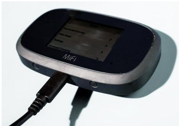
3. Cuando la batería esté completamente cargada, mantenga presionado el botón de encendido (botón n. ° 1 en el diagrama anterior) durante 3 segundos para encender el dispositivo.
