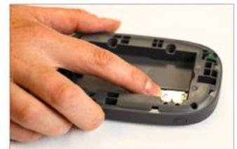
Alinee los contactos dorados de la batería con los contactos dorados del Jetpack y deslice suavemente la batería en su lugar.
